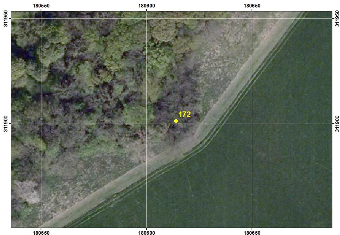
Figuur 6.1: Risicopunt 172 van de Schone Grub (Savelsbos). De 10-15 m brede bufferstrook is ter hoogte van het risicopunt verdwenen door terugschrijdende erosie van de grubbe (zie ook Figuur 5.8; luchtfoto voorjaar 2015).
