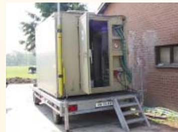
Meetunit voor stalemissiemetingen opgesteld bij Bomers in Eibergen.
