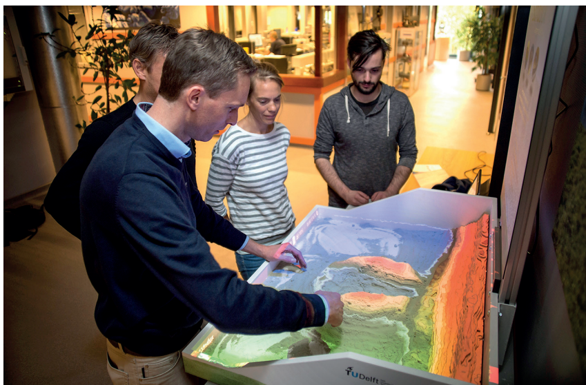
Afbeelding 2 – In de SandBox modelleren je de kustlijn in het zand en daar wordt een beeld van de gesimuleerde waterstroming overheen geprojecteerd.
