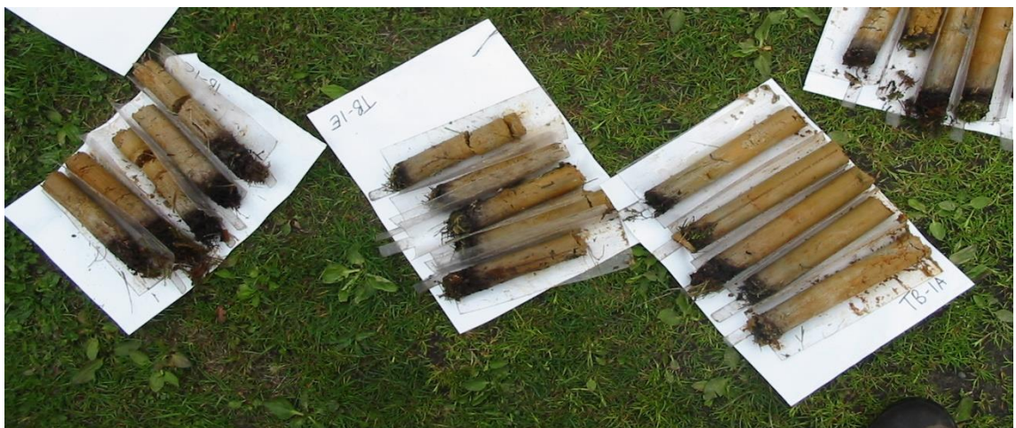
Afbeelding 2. Bodemonsters met duidelijke verschillen in organisch stofgehalte tussen de lagen.
