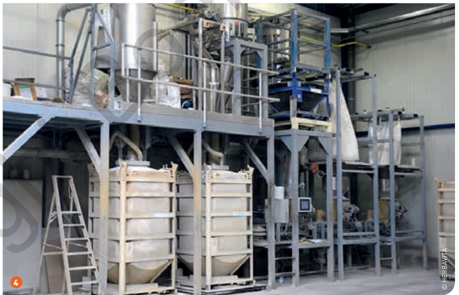
1 Dankzij scanners kunnen grondstoffen getraceerd worden tot in de verpakking. 2 Hier worden de likemmers voor koeien en paarden gevuld. 3 In deze silo's worden de grondstoffen bewaard. 4 Alles wordt gemengd in kleine containers waardoor contaminatie vermeden wordt.
