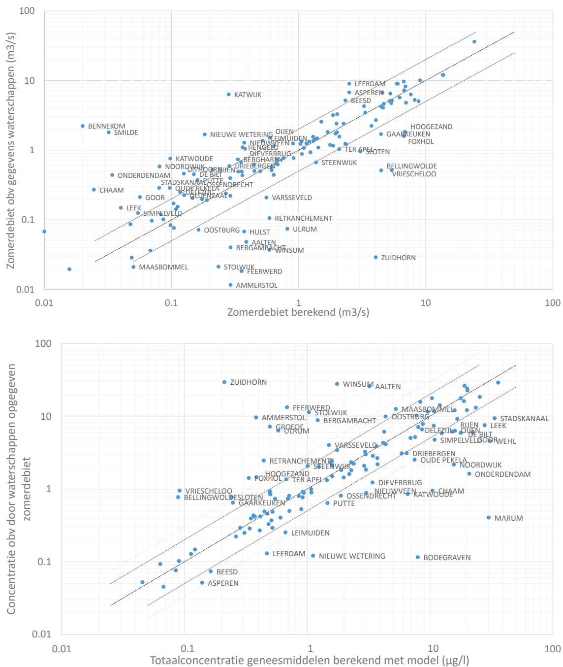
FIGUUR B8-6 VERGELIJKING BEREKENDE EN DOOR WATERSCHAPPEN OPgegeven ZOMERDEBIETEN (BOVEN) EN (BENEDEN) DE DAARUIT BEREKENDE CONCENTRATIEBIJDRAGEN IN DE ONTVANGENDE WATERLICHAMEN. SCHAAI IS LOGARITMISCH
