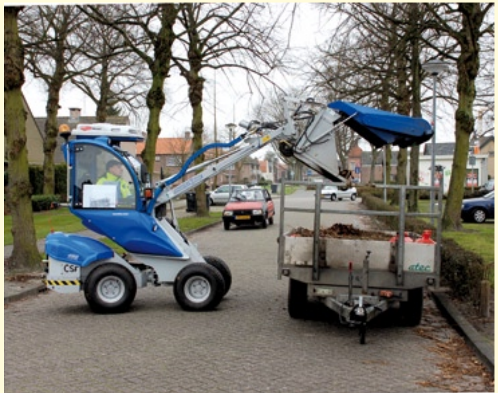
Het legen van de opvangbak gaat eenvoudig, tot 190 cm hoog, in een aanhanger die de Poop scoop achter zich aan trekt bij het verplaatsen tussen hondenvelden.
