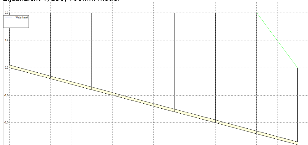
FIGUUR 14 ZIJAAZICHT MODEL MET VERHANG 1:250 EN DIAMETER 100 MM.
