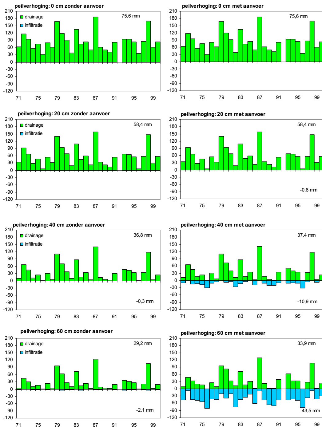
Figuur 4.11. Drainage u_i (positief) en infiltratie i_i (negatief) in het doorgerekende perceel bij een peilverhoging van 0, 20, 40 of 60 cm zonder en met aanvoer van oppervlaktewater gedurende de periode 1 mei t/m 31 augustus (1971 – 2000). In de figuren zijn ook gemiddelden weergegeven (zie Tabel 4.2) voor het kleiprofiel.
