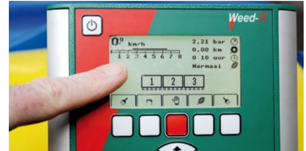
Met het doorlopen van de verschillende menu's is de Weed-IT in te stellen. Ook het in- en uitschakelen kan met één druk op de knop. Tijdens het spuiten kun je de informatie aflezen op het display.
