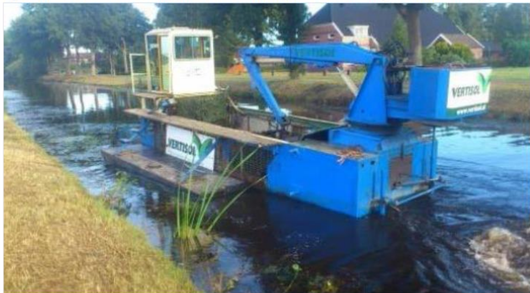
Figuur 6: De maaiverzamelboot van Vertisol (foto waterschap Velt en Vecht)
