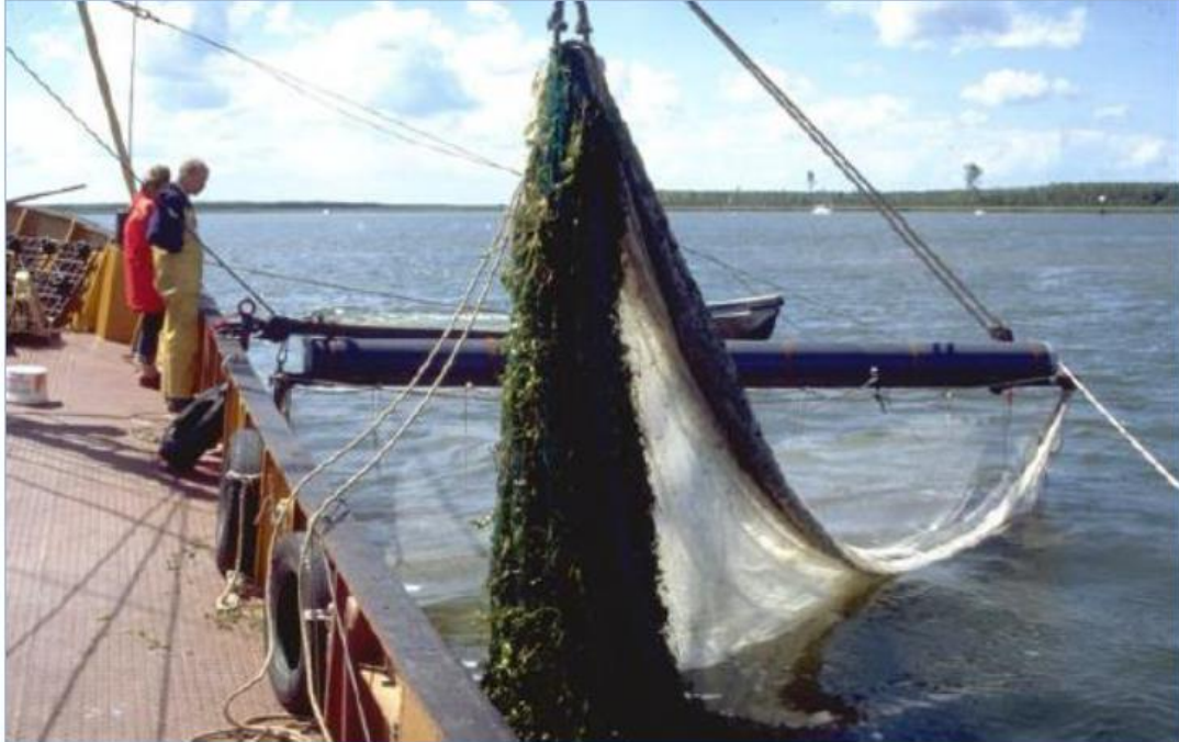
Figuur 7: De maaikor (foto Rijkswaterstaat IJsselmeergebied)
