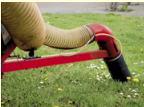
De zwenkarm voorop, met de slang van 125 mm, heeft een bereik van bijna 2 meter.
