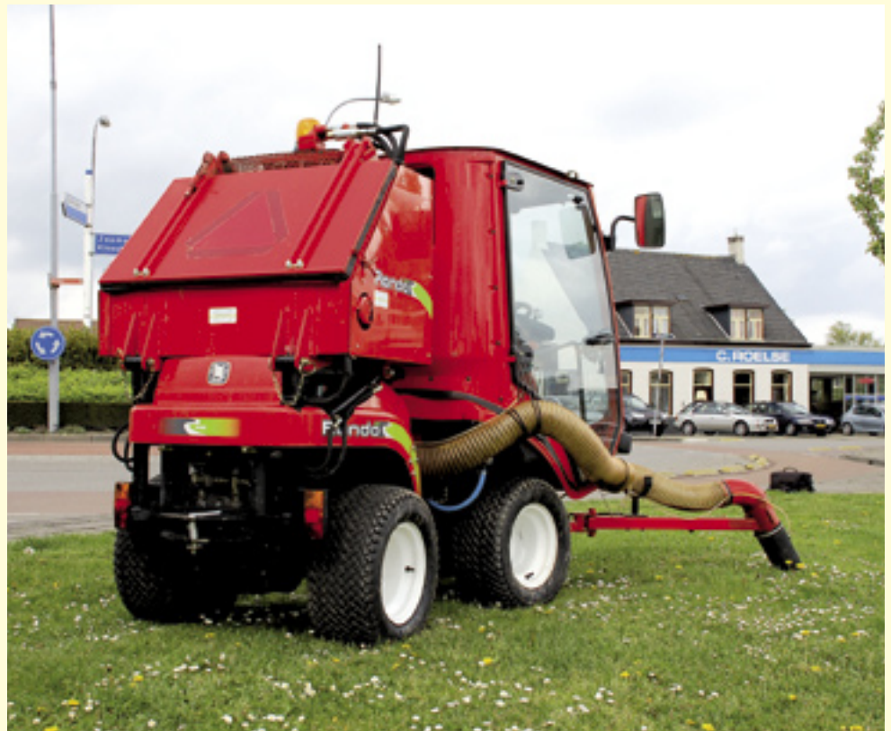
De vacuümcontainer is hydraulisch leeg te kiepen. Bovenop de container zit de ventilator. In de container zitten ook een watertank en een tank met hydrauliekolie.
