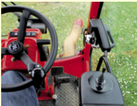
De zwenkarm is met een joystick op de rechterarmleuning te bedienen.
