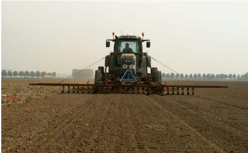
Figuur 1 Rijpadentrekker met rubber rupsen en RTK-DGPS besturing
