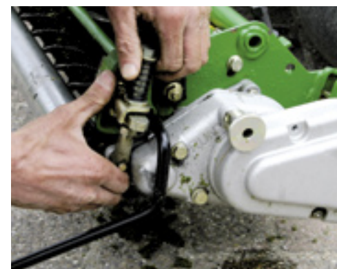
De groomer kun je op twee manieren uitschakelen: door de aandrijving los te koppelen (links) of door deze alleen naar boven te zetten en gewoon te laten meedraaien. Zo voorkom je verstoppingen.
