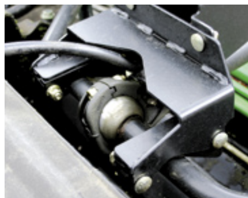
De kooien zijn pendelend opgehangen via een kogelgewricht.
