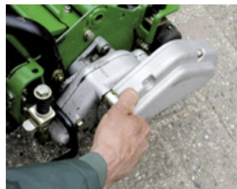
De groomer kun je op twee manieren uitschakelen: door de aandrijving los te koppelen (links) of door deze alleen naar boven te zetten en gewoon te laten meedraaien. Zo voorkom je verstoppingen.
