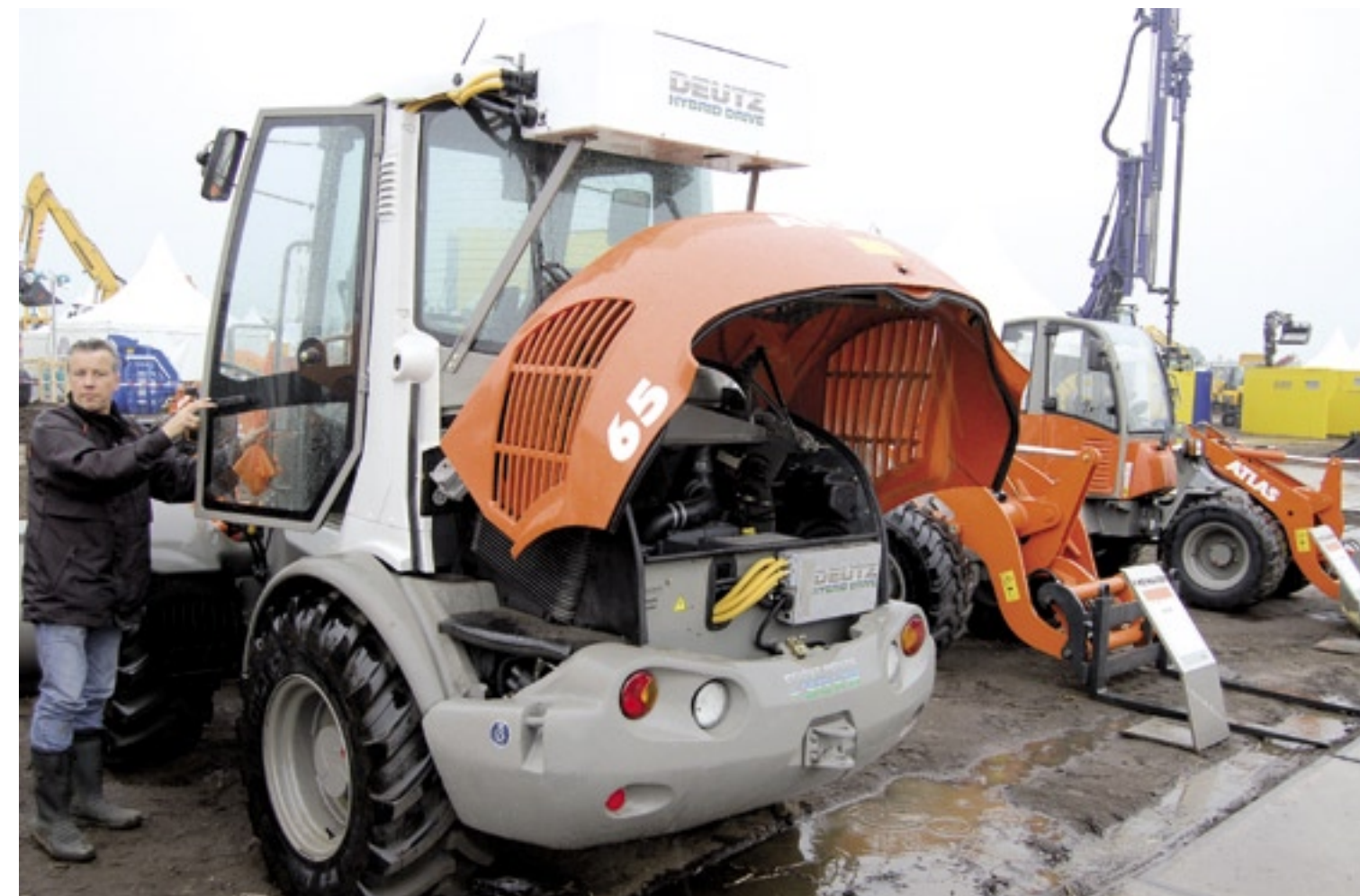
Atlas en Deutz shovel met hybride aandrijving.
