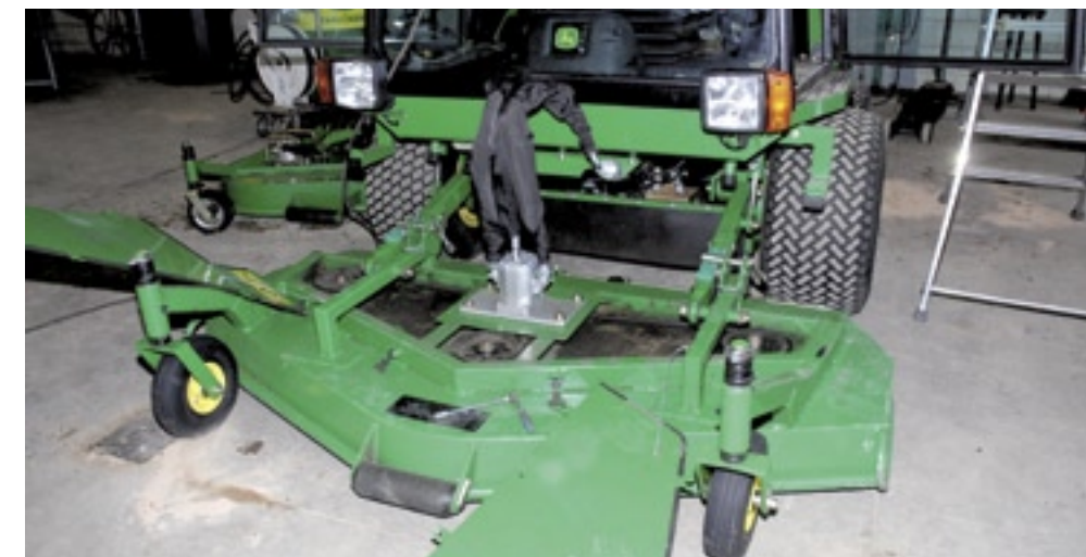
Een maaidek van een cirkelmaaier met een hydraulische aandrijving. Wanneer je de beschermplaten wegneemt, is de mechanische aandrijving met de V-riemen zichtbaar. Bij deze maaimachine heeft de as van de centrale aandrijfunite een dubbele V-riemschijf.
