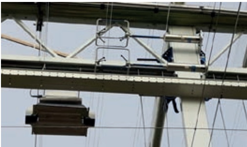
Figuur 3 De geïnstalleerde 3D anemometers tussen de schermen.
