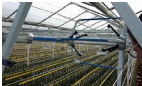
Figuur 3 De geïnstalleerde 3D anemometers tussen de schermen.
