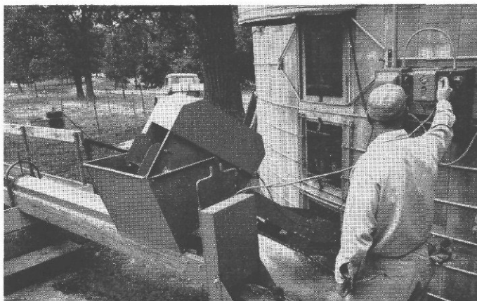
Afb. 42. Torensilo met automatische onderlosser.
