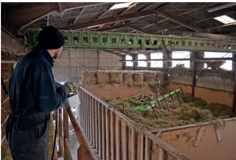
Met een soort kermisgrijper brengt Aldert losgestort hooi voor het voerhek.
