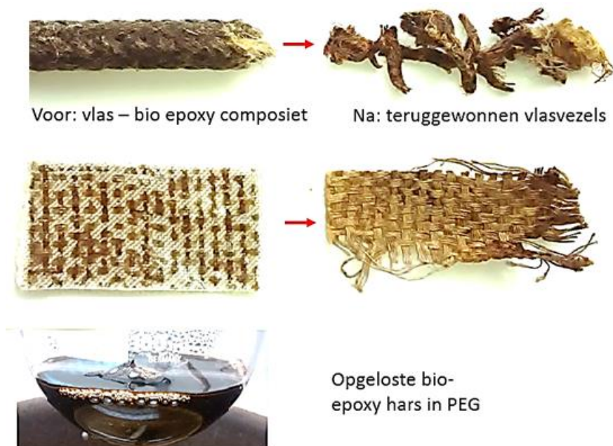
Afbeelding 6 Resultaten van solvolyse proeven bij Avans met vlas/bio-epoxycomposiet (foto A. Hoogendoorn)
