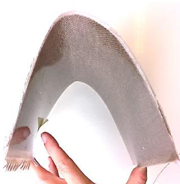
Afbeelding 38 Resultaat (onverwacht) van een reactie met Biothan en vlasmat. De cellulosecomponent in het vlas heeft gereageerd met de isocyaanaat harder
