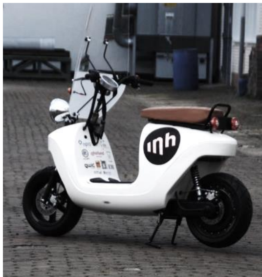
Afbeelding 47 Biocomposiet scooter (SIA RAAK Project 2010), http://sofa.innoventuri.com/media/
