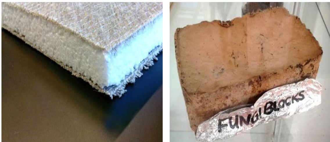
Afbeelding 16 Voorbeelden van een typisch kernmateriaal (PLA, links) en een atypisch, nieuw kernmateriaal (fungiblok, rechts)
