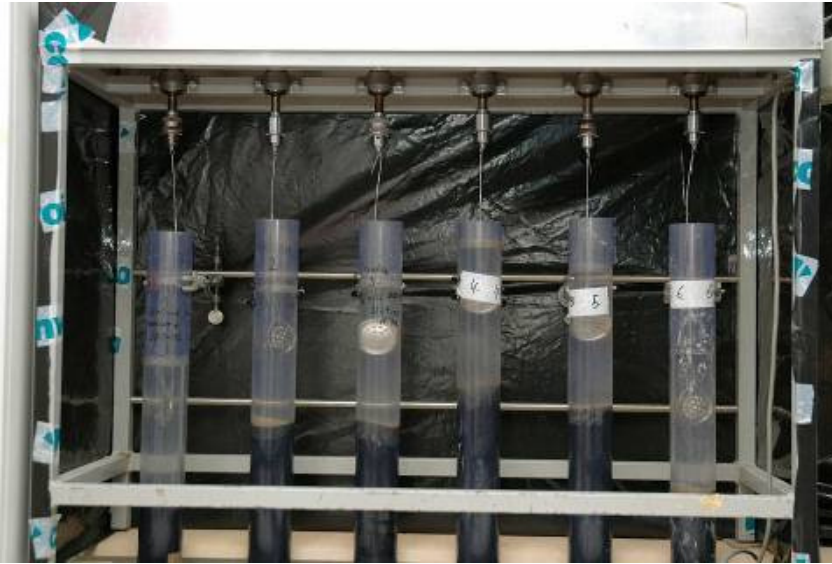
Figuur 1: Opstelling voor fluxmetingen (AEW labs).
