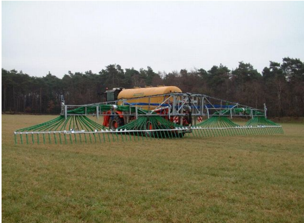
Figuur 5. Sleepslangenmachine; de mest wordt in stroken op het gras gelegd.
