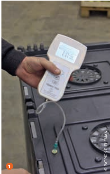
1 Adrien meet 2,2% zuurstof en 4,3% CO 2 in de MT-pallox, mooi binnen de maatstaven dus. 2 Simon Vervisch ziet als groot voordeel van MT-bewaring dat hij tot laat in het voorjaar Elstar kan blijven aanbieden in zijn thuisverkoop.
