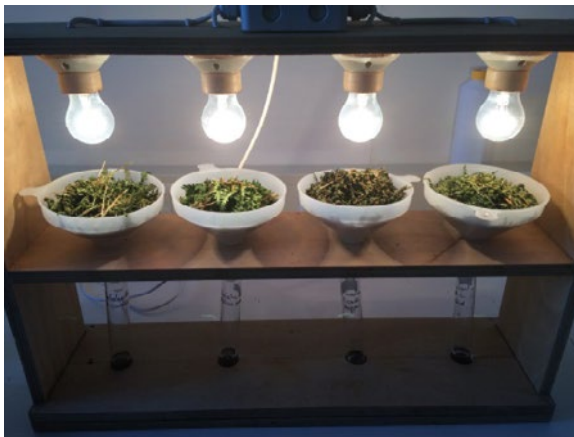
Foto 9.7 Overzicht extractie met behulp van Berlese trechters met 4 x 100 Watt lampen (Foto: NVWA).
