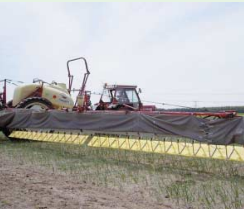
Sleepdoek geeft een emissiereductie van meer dan 90 % ten opzichte van de gangbare spuitdop. De effectiviteit met sleepdoek blijkt goed. Er ontstaat geen gewasschade.
