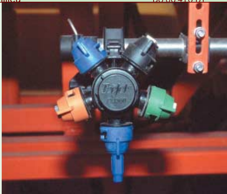
De onderste buisvormige dop geeft 75% minder drift dan de standaard dop, maar kan in veel gevallen worden gebruikt zonder afname van effectiviteit.
