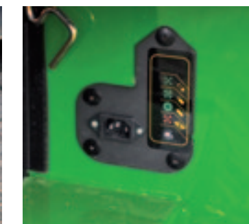
John Deere levert op de Gator een kort driepolig snoertje. Daaraan past dan weer een verlengsnoer.
