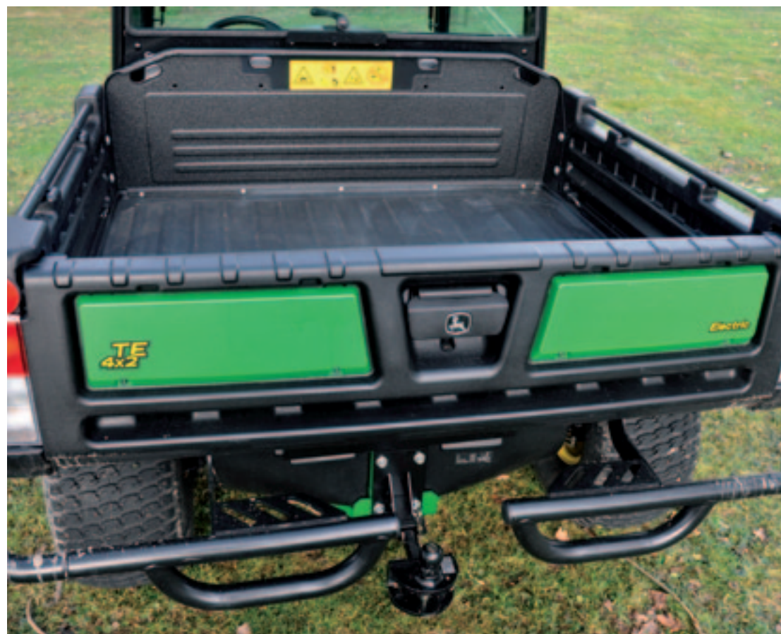
De bak van de John Deere is de laagste en grootste en daardoor de meest praktische van het stel. De bak is bovendien als enige voorzien van sjoer-ogen waarmee je de lading kunt vastzetten.
