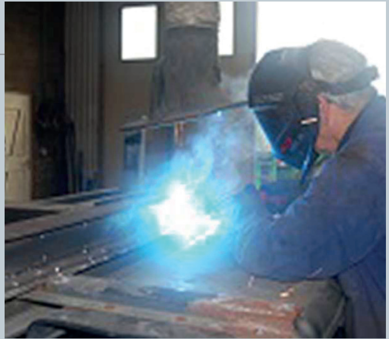
Het verschil tussen het lassen met of zonder bronafzuiger is duidelijk zichtbaar. Zorg ervoor dat de lasrook niet in de ruimte blijft hangen. Ventileer waar mogelijk.
