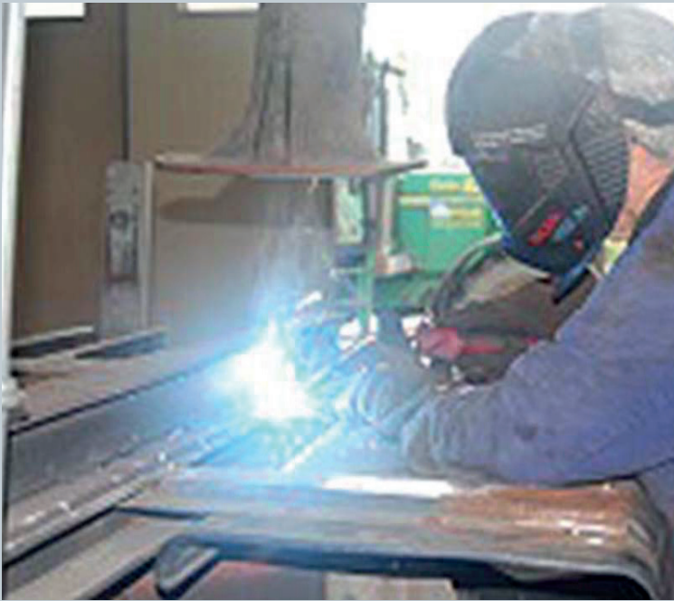
Het verschil tussen het lassen met of zonder bronafzuiger is duidelijk zichtbaar. Zorg ervoor dat de lasrook niet in de ruimte blijft hangen. Ventileer waar mogelijk.
