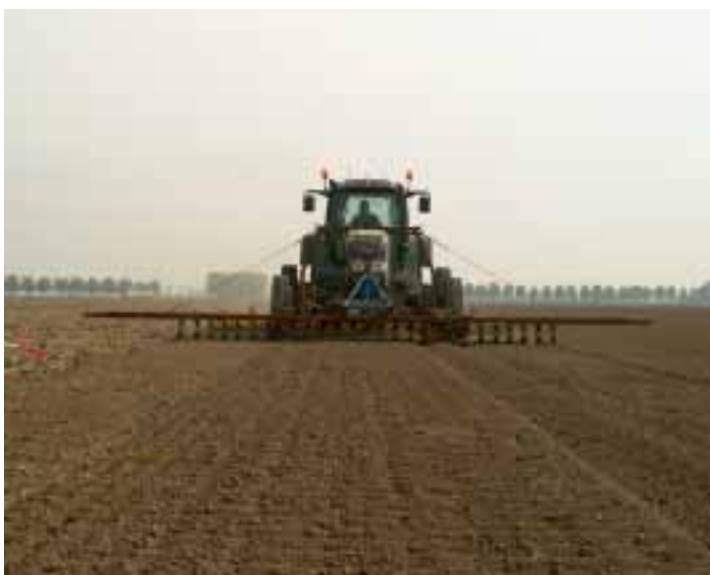
Vaste rijpaden met een spoorbreedte van 3,15 meter voorkomen onnodige bodemverdichting, maar hebben grote gevolgen voor het werktuigenpark.
