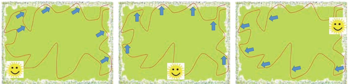
Figuur 9 Ongeacht hoe zon en wind zich situeren in je gebied, heb je steeds windluwe en warme plekjes in de sinusranden.
