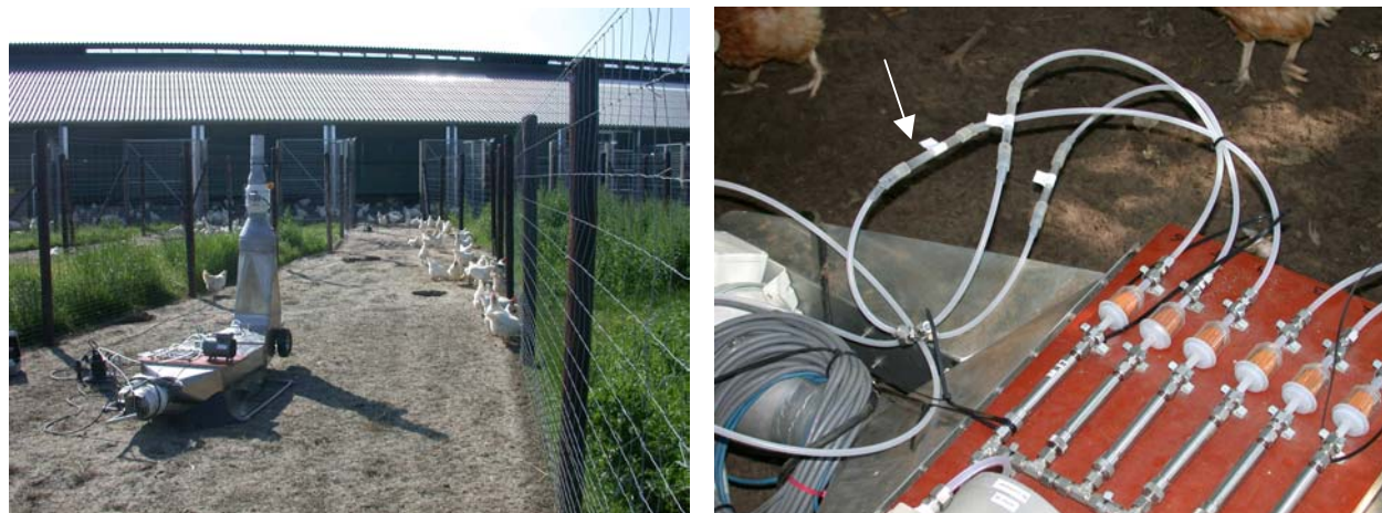
Figuur 3 De meetdoos en een detail van de denudermethode (pijl is gericht op een dunuder)
