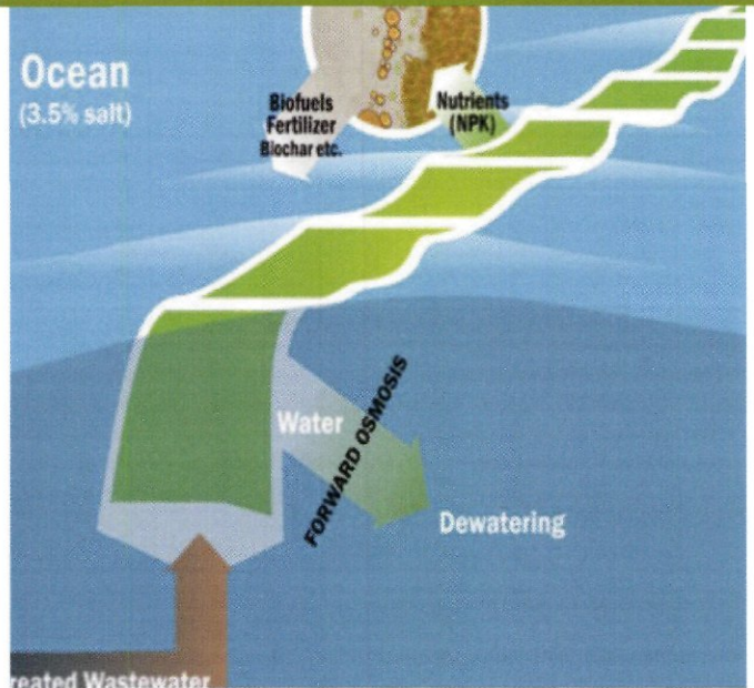
Een door NASA ontworpen systeem om met afvalwater op zee algen te kweken.
