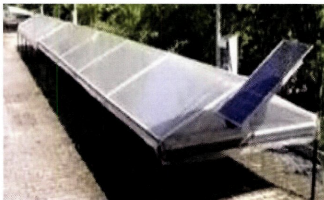
De zonnendroger die met hoog rendement en zonnenergie algen droogt om ze daarna te kunnen verwerken.
