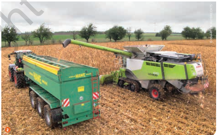
1 De camera op de uitwerpbuis scant continu de omtrek van silagewagen. Hierdoor wordt het vullen van de maïs-wagen geautomatiseerd, zodat de chauffeur daar geen aandacht meer voor moet hebben. De volle Cargos-wagen kan het gewicht doorgeven en kan eveneens afgedekt worden. 2 Bodemvriendelijk werken met rupsen onder de dorser en veldvervoer met overlaadwagens op grootvolumebanden..
