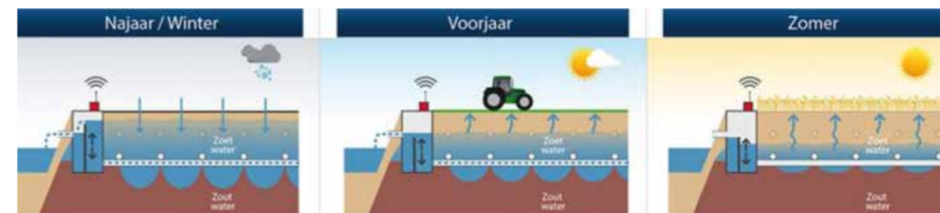
Figuur 3.3: Principe van peilgestuurde drainage voor een efficiënter zoetwaterbeheer, met een groter waterbergend en vochtleverend vermogen, en het tegengaan van verzilting (Spaarwater).
