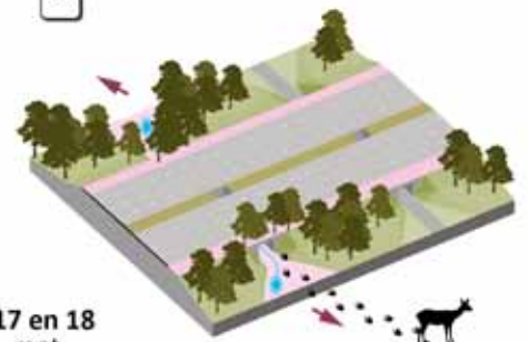
Kleine faunatunnel, met geoptimaliseerde toeleidingen en Onderdoorgang Wijde Veldweg met lichttoetreding en aangepast talud noordzijde.
