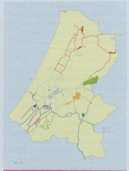
Afb. 1: Met de circa 100 noodwaterkeringen kan Rijnlands boezem in negen compartimenten worden verdeeld.
