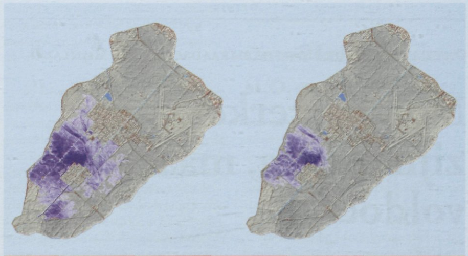
Afb. 2: Gevolgen van een doorbraak aan de westzijde van de Haarlemmermeer zonder (links) en met (rechts) inzet van noodwaterkeringen.
