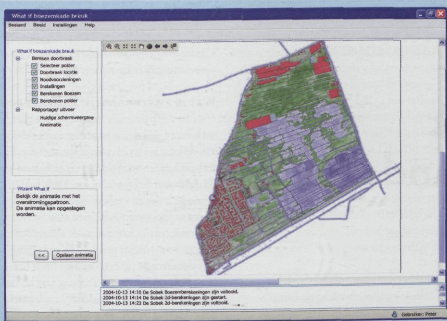
Afb. 4: Weergave van een beeldscherm met daarop de 'Lizard'- module waarbij de gevolgen van kadebreuk in beeld zijn gebracht voor een polder.
