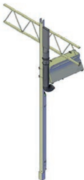
Figuur 1 Tekening van de luchtaanzuiging van boven het scherm in combinatie met de OPAC warmtewisselaar.
