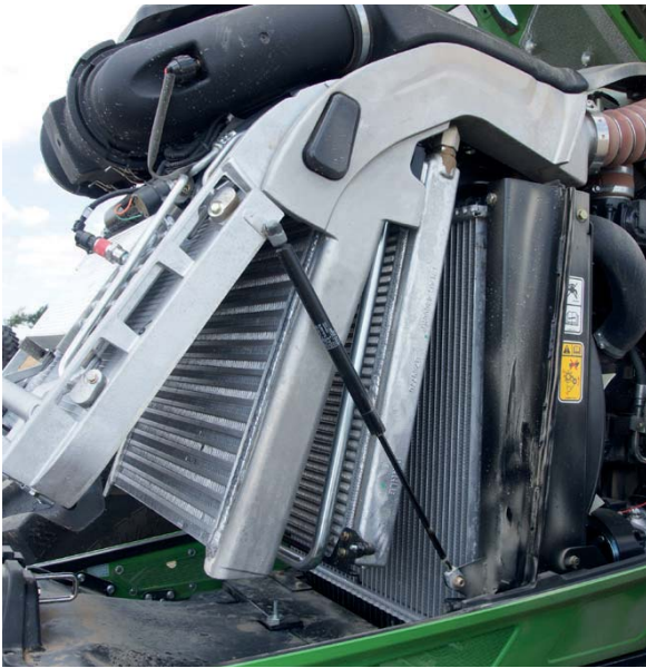
Het koelpakket is nu volledig aluminium en kan eenvoudig worden opgeklapt om het schoon te maken. Boven het koelpakket ligt nu het luchtfilter.
