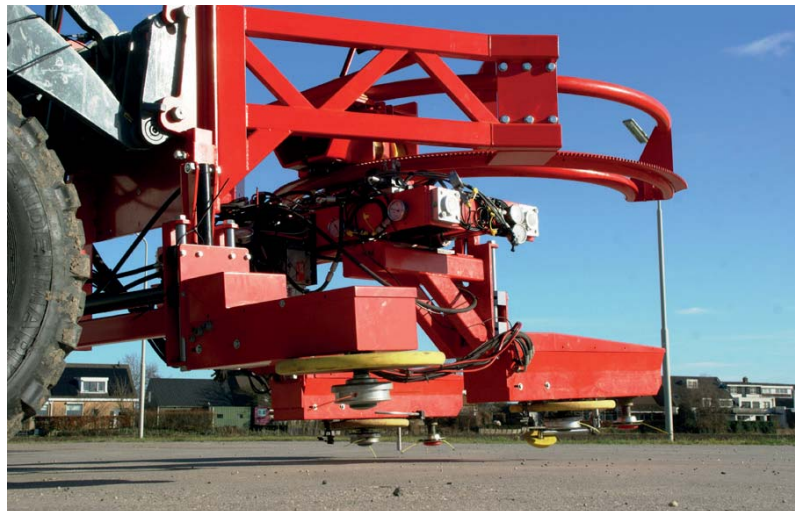
De zijmaaier nog met enkele maaikop. De volgende versie wordt scharnierend, roterend en de uitschuifbare arm kan onder een hoek van twintig graden worden gezet met een dubbele maaikop.
