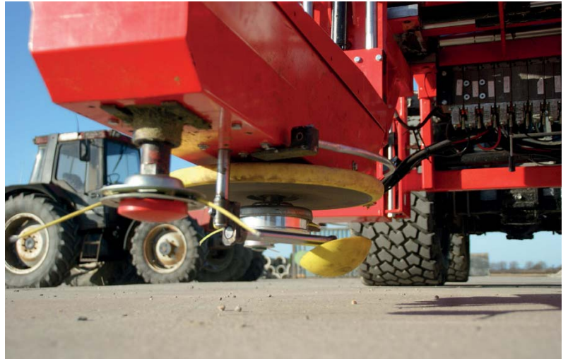
De tasters voor de breedte en diepte op de carousel zitten zo dicht mogelijk op de maaikop voor een altijd gelijkblijvend maaieresultaat. Het binnenhalen van Deutz-Fahr
