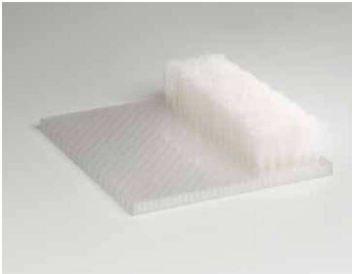
Bodemplaat van PET met ingestanste ‘haren’ van PLA
