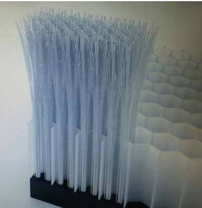
PLYSKIN lagen: haar, honingraat en absorberende bodem met PCM
