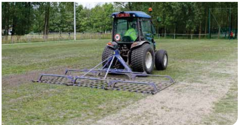
De verschraling wordt uitgevoerd met bezandingsmachine met daarna machinaal inponsen en vullen d.m.v. een sleepnet.
