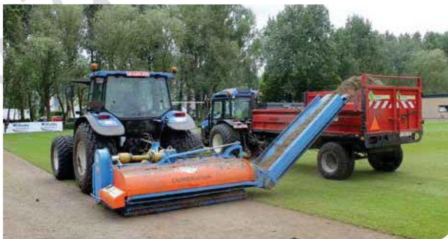
Bij het topfrezen wordt alleen de bovenste laag weggehaald waardoor de wortels en de groeipunten blijven zitten.
