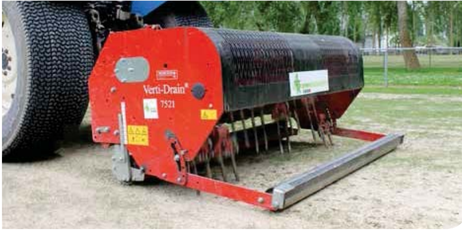
Gemiddeld wordt elk veld viermaal per jaar geprikt om goed te beluchten
