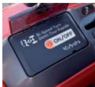
Bij frezen is Bi-Speed een mooie techniek om bij het keren de voordelen van vierwielaandrijving te behouden. Maar op een gazon wil je niet dat de voorwielen bij een scherpe bocht ineens veel sneller gaan draaien. Vandaar dat je Bi-Speed met een druk op de knop kunt uitschakelen.
