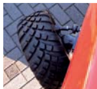
Door het gebruik van portaalassen kun je compacttrekkers met vierwielaandrijving toch heel scherp laten draaien.
