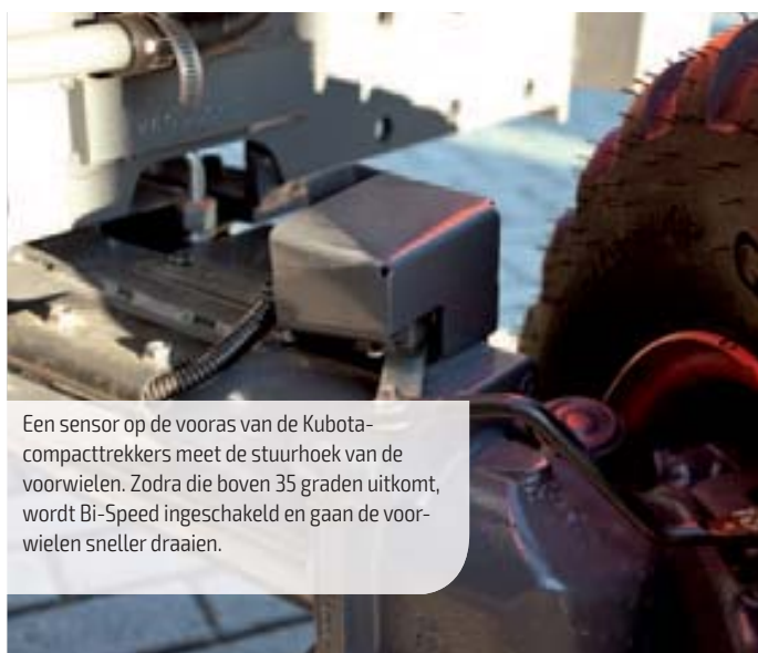
Bij frezen is Bi-Speed een mooie techniek om bij het keren de voordelen van vierwielaandrijving te behouden. Maar op een gazon wil je niet dat de voorwielen bij een scherpe bocht ineens veel sneller gaan draaien. Vandaar dat je Bi-Speed met een druk op de knop kunt uitschakelen.
