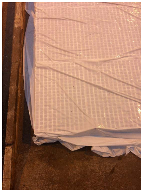
Figuur 54: Trays op de betonnen vloer, afgedekt met wit folie
