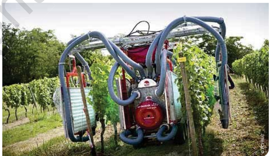
Beate Berkelmann-Löhnertz van de Universiteit van Geisenheim ontwikkelde een veldtoestel voor de bestrijding van botrytis met uv C-licht, al dan niet in combinatie met fungiciden.
