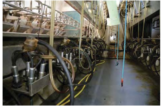
De koeien worden gemolken in een 2 x 12 stands zij-aan-zij Hudonk-melkstal van BouMatic.
