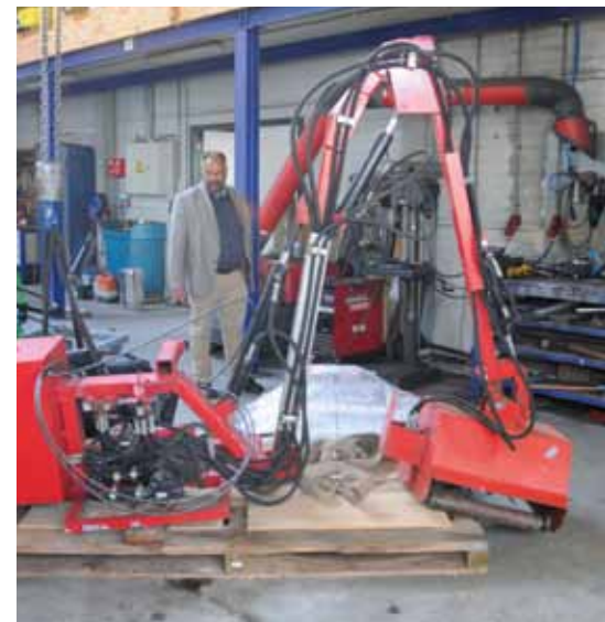
Van een oude maaiarm wordt een nieuwe heteluchtmachine gebouwd
