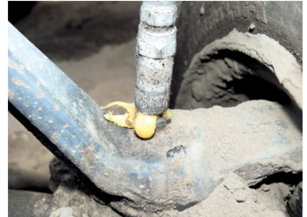
Als de vetnippel verstopt is of beschadigd, dan spuit het (meeste) vet langs de nippel. De nippel vervangen, voorkomt onnodige stilstand en kosten.
