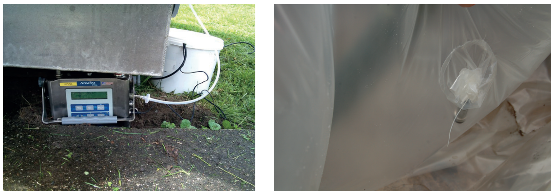
FIGUUR 3.3 WAAKHOND EN OPENING KELDERBALLON T.B.V. PLAATSING APPARATUUR
