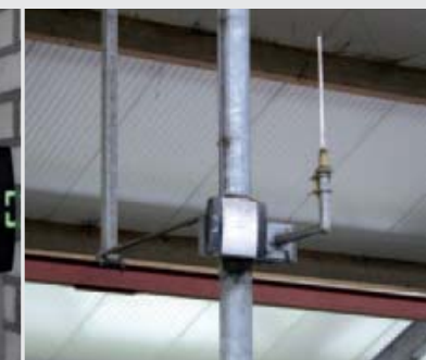
De antenne stuurt de data van de verschillende tags door naar de process controller.
