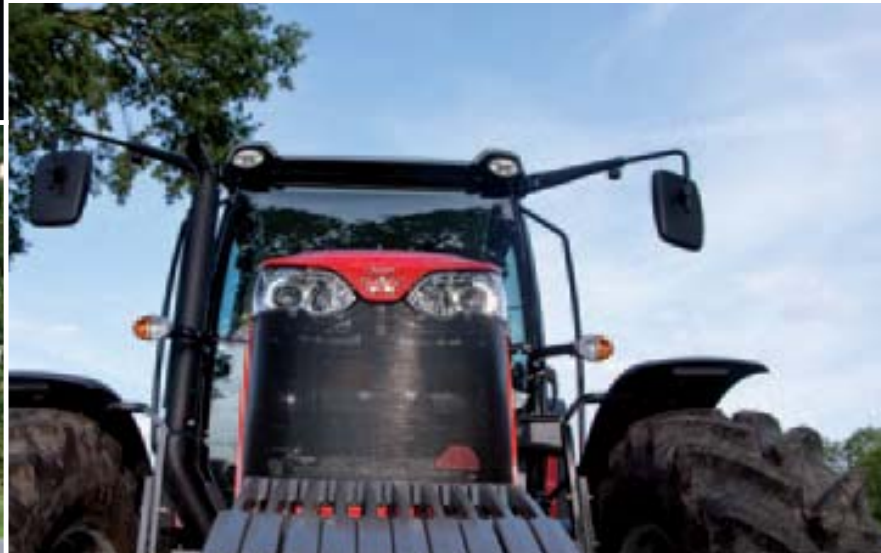
De Global-serie heeft het stoere familiesmoelwerk van de luxueuse Massey Ferguson-modellen gekregen. De motorkap kan voor onderhoud in zijn geheel omhoog. Daarna zijn alle dagelijkse onderhoudsklussen goed uit te voeren.
