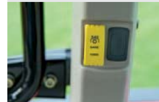
De trekker heeft een 540/540eco-toerenaftakas. Optie is een 1.000-toerenschakeling.
