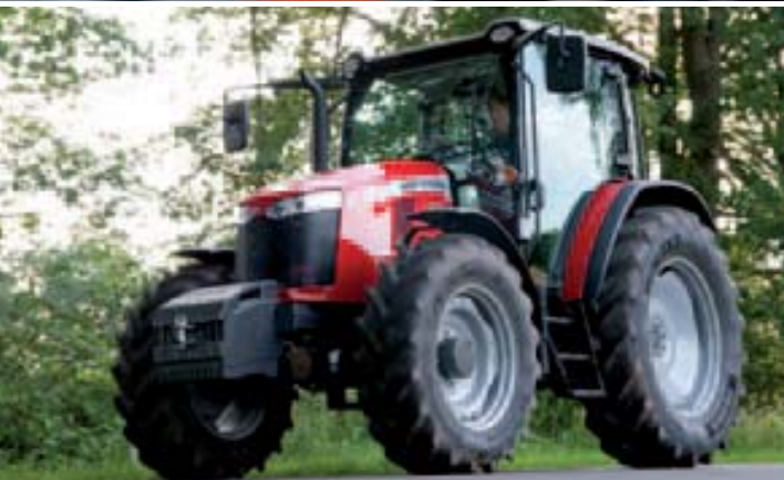
De 5700 heeft zeven versnellingen tussen 5 en 12 km/h. De top ligt op 40 km/h. Optie is een kruipbak. Je hebt dan 24 versnellingen voor- en achteruit met een minimale snelheid van 150 m/h.
