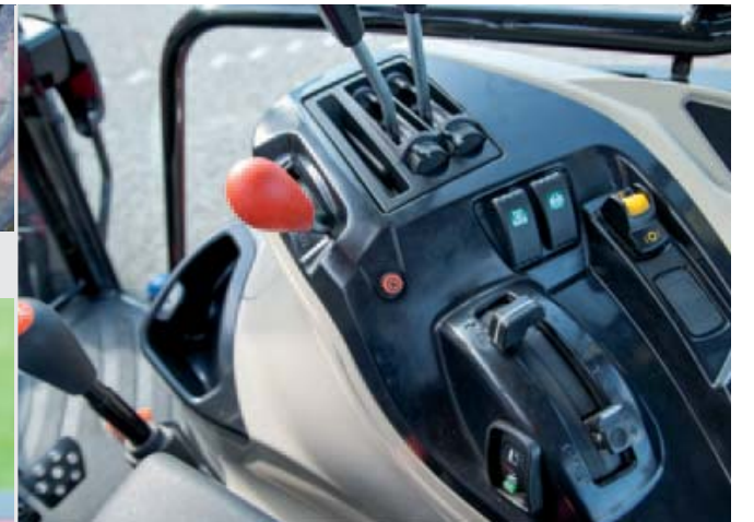
De meeste bedieningshendels hebben een logische plek gekregen op het rechterspatbord. De elektronische hef laat zich met een schuif bedienen als een mechanische.
