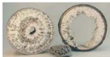
Teruggewonnen struviet (links) en verstopt leidingwerk (rechts)
